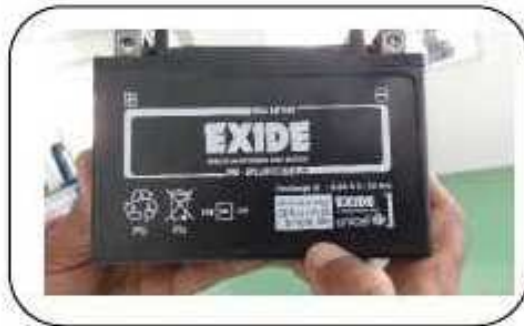
Bateria Libre de Mantenimiento Free 12 v 8 Ah
