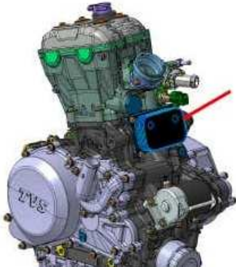
OWHE montado en el cárter superior - Motor delantero
