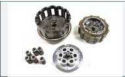
Embrague Pesado de 6 Platos para Transferir los 35 hp para quemar goma
