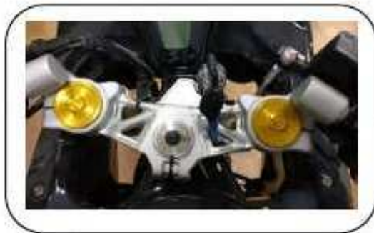
Triple Clamp Forjado y Terminación de Primera
