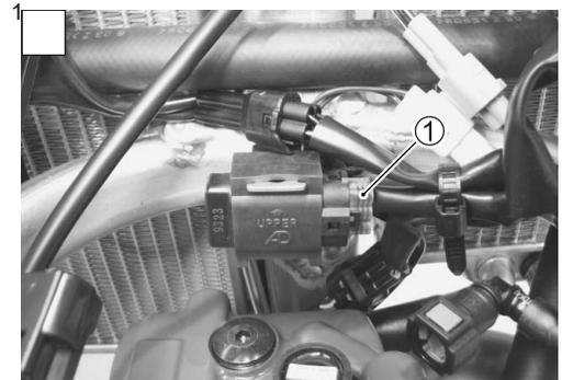
4) Desconecte el acoplador del sensor TO y el acoplador ECM.
