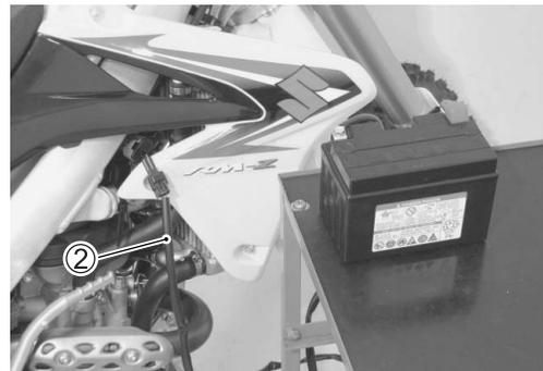
**Antes de verificar el DTC, no desconecte el acoplador del cable del ECM.**
