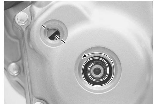
**Después de este procedimiento, si siente alguna resistencia al girar el cigüeñal, deténgase inmediatamente y verifique la sincronización de la cadena del árbol de levas.**
