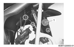
5) Loosen the front fork upper clamp bolt (2).
