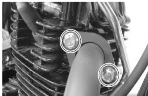
Apriete los tornillos del exosto y las tuercas y tornillos de montaje del silenciador de acuerdo a los torques especificados:
