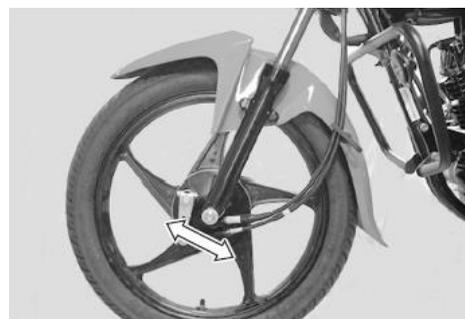
causar inestabilidad. Revise que la horquilla delantera no esté suelta. Sostenga la motocicleta en una posición en que la llanta delantera no toque el suelo. Con la rueda apuntando directamente al frente, sujete las barras inferiores de la horquilla cerca al eje y hale hacia adelante. Si está muy suelto, la dirección debe ser ajustada de nuevo.
