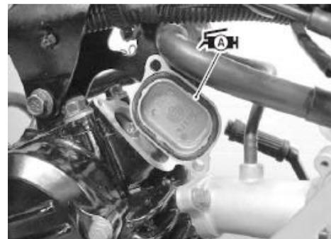
**AH** Aplicar SUZUKI SUPER GREASE “A”
