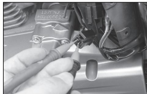
**INSPECCIÓN DE LA SALIDA DE CARGA**
