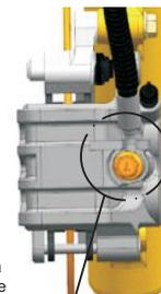
Coloque el racor de la manguera del freno en la ranura de la pinza y apriete el perno.
