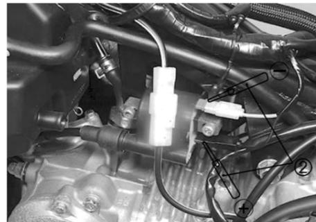
**Resistencia de la bobina de encendido**
