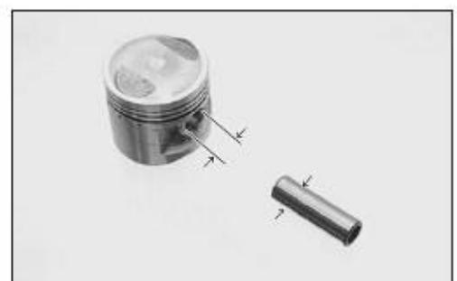
**TOOL** 09900-20605 : Calibrador de interiores
