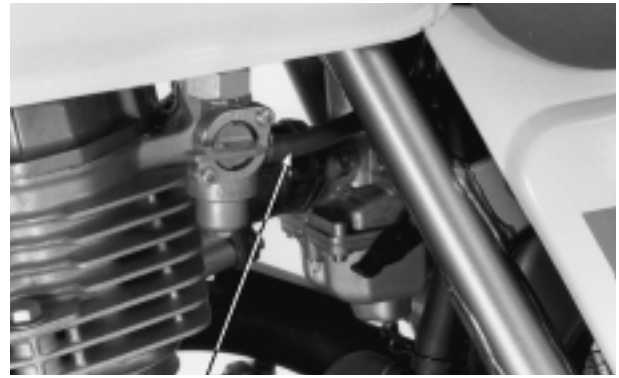
TUBO DE COMBUSTIBLE
