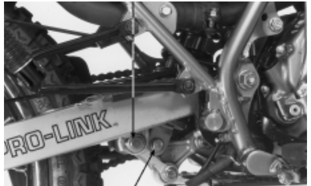
TORNILLO DE SUJECION INFERIOR TORNILLO ENTRE EL VASTAGO DE CONEXION Y EL BRAZO OSCILANTE
