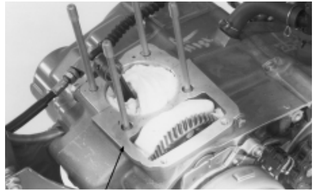
SUPERFICIE DE LA EMPAQUETADURA
