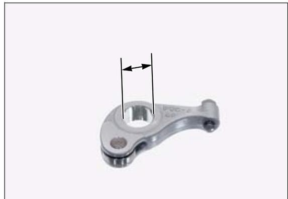
Compruebe la existencia de desgaste o daños en la superficie deslizante del eje de balancines.
