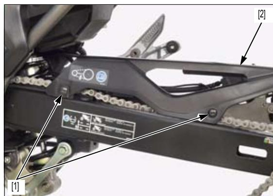
X/XA/S/SA: Desmonte los tornillos de cabeza embutida [1] y la guía del manguito del freno [2].
