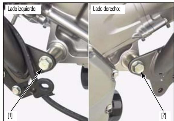
Apriete el tornillo del cáncamo de suspensión del motor superior izquierdo [1] al par especificado.
