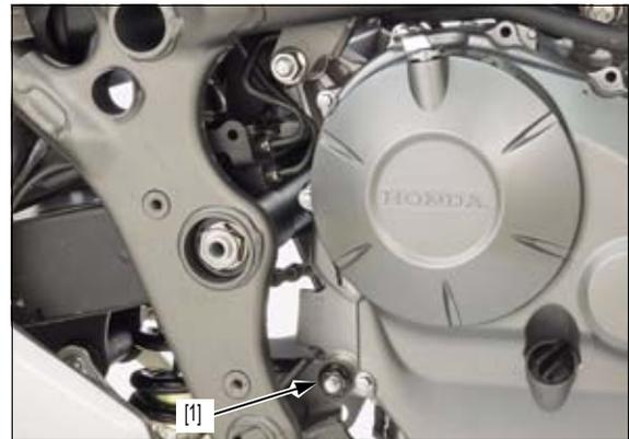
Apriete el tornillo del cáncamo de suspensión inferior delantero izquierdo del motor [1] al par especificado.
