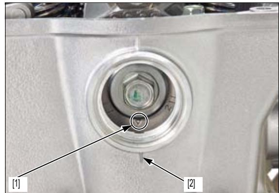
Desmonte los tornillos del eje de balancines [1].
