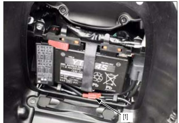
Conecte el conector 4P (Verde) de la electroválvula lineal [1] e insértelo en el soporte del modulador del ABS.
