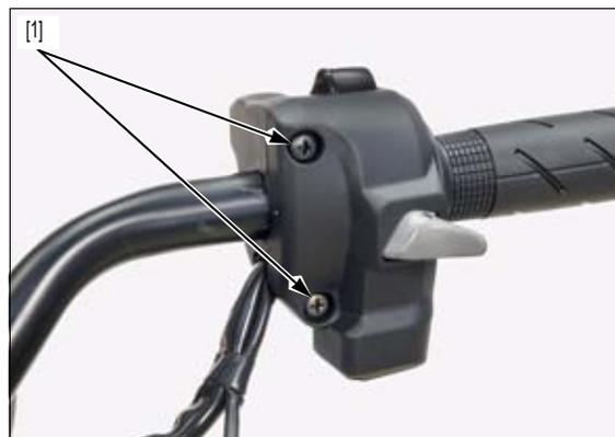
X/XA/S/SA: Monte los tornillos [1] y apriete primero el tornillo superior y, a continuación, el tornillo inferior al par especificado.
