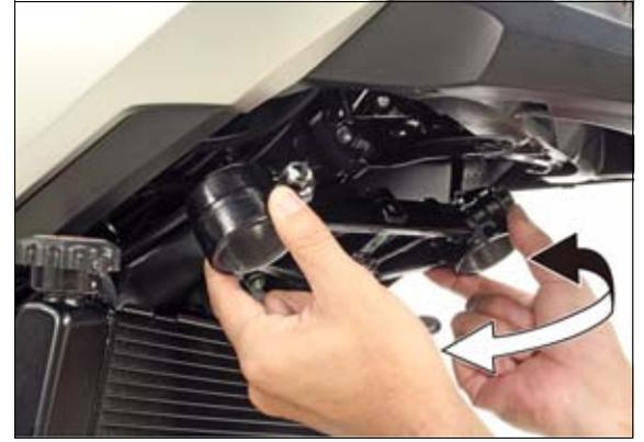
Vuelva a apretar la tuerca de ajuste [1] al par de apriete especificado con una herramienta especial.
