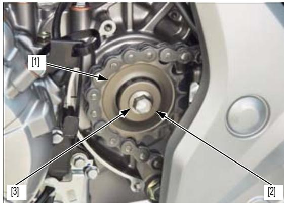
Monte el cable de masa [1] y el tornillo de fijación del motor de arranque [2].
