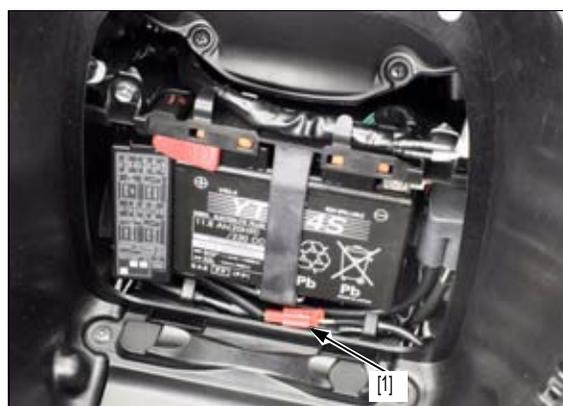
Desconecte los conectores 3P [1] del sensor de EOP del embrague.
