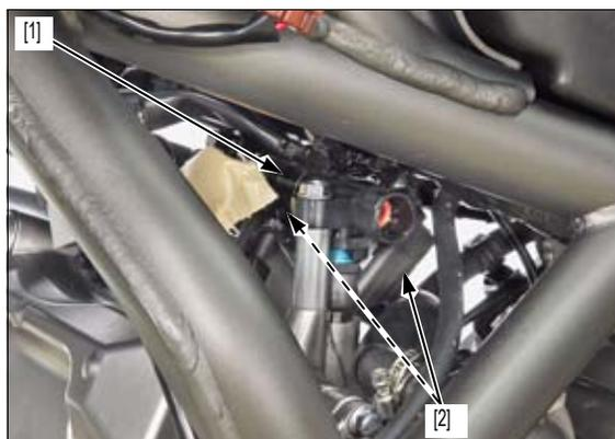
Conecte el conector 3P (Negro) del sensor de VS [1] y el conector 2P (Negro) del sensor de EOT [2].
