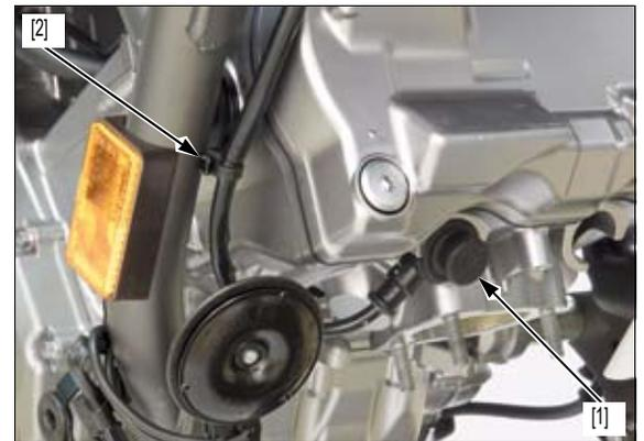
Desmonte los tornillos [1] y el soporte [2] del bastidor.
