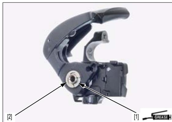
Instale el eje de liberación [1] y un nuevo pasador del muelle [2] mientras alinea el orificio del eje de liberación, el trinquete A y el soporte de la palanca del freno de estacionamiento.
