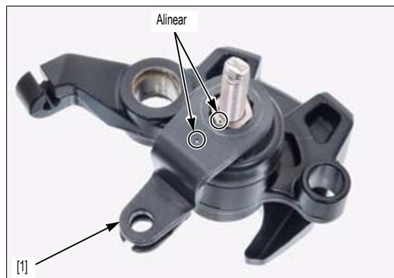
Instale la contratuerca [1] al par de apriete especificado mientras sujeta el brazo del freno [2].
