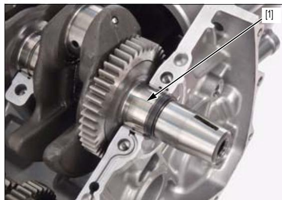
Monte los pasadores de centrado [1] y los orificios de aceite [2] en el cárter motor superior [3].
