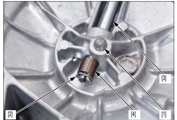
Compruebe que no haya daños o desgastes en el eje de la palanca del elevador [1].
