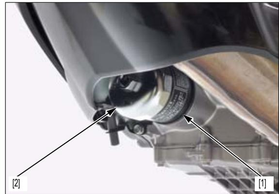
Compruebe que el cubo del filtro de aceite sobresale del cárter motor en la longitud especificada, como se indica.
