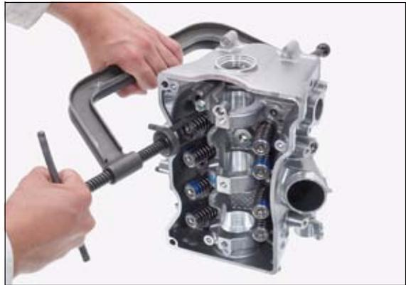
Para asentar firmemente las chavetas, golpee ligeramente los vástagos de la válvula con un martillo de plástico y un eje.
