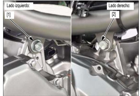
Apriete la tuerca del cáncamo de suspensión superior trasero del motor [1] al par especificado.
