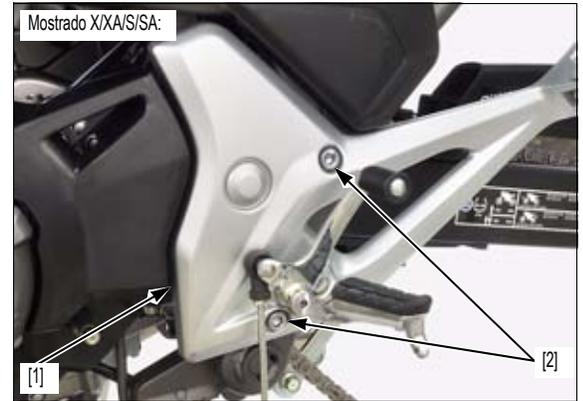
X/XA/S/SA: Monte el brazo del cambio [1] en el eje del cambio.
