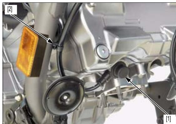
Desmonte los tornillos [1] y el soporte [2] del bastidor.
