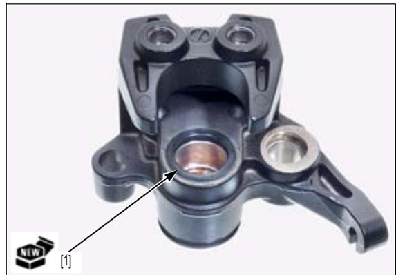
Aplique un mínimo de 0,4 g de grasa de silicona a la superficie exterior del eje del freno [1].
