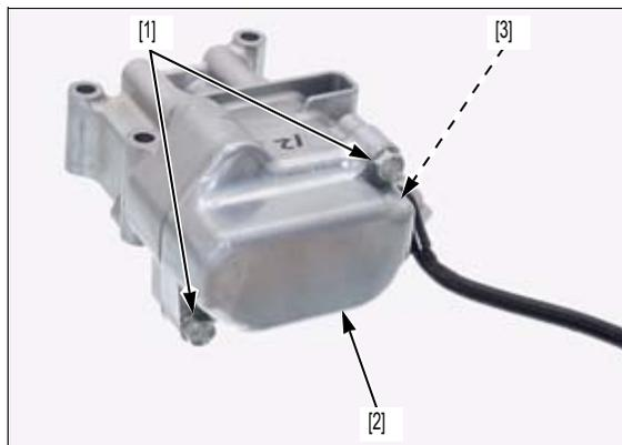
Extraiga el tornillo [1], las electroválvulas lineales [2] y la placa de tope [3] del cuerpo de la válvula.
