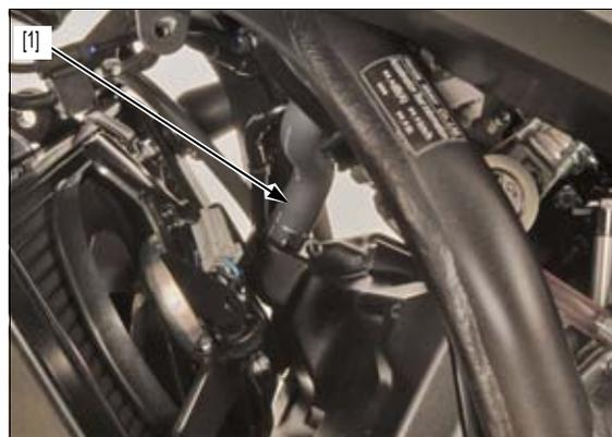
Afloje el tornillo de la abrazadera del manguito de conexión del filtro de aire [1].
