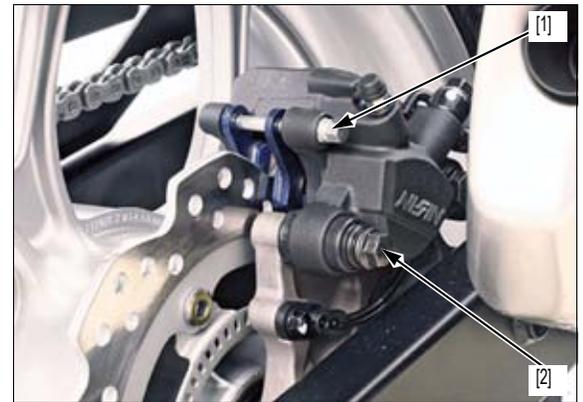
*Una vez desmontadas las pastillas de freno, no accione el pedal del freno.*
