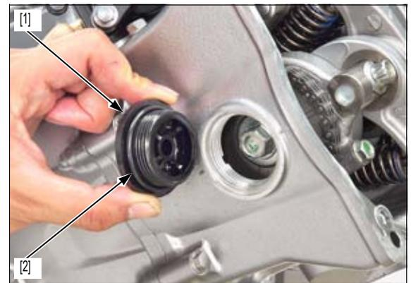
**Cilindro N.º 1:** Gire el cigüeñal en el sentido antihorario y alinee la marca "1T" [1] sobre el volante de inercia con la muesca de referencia [2] en la tapa del alternador.
