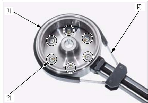
Desmonte el conjunto del embrague del motor de arranque [1].
