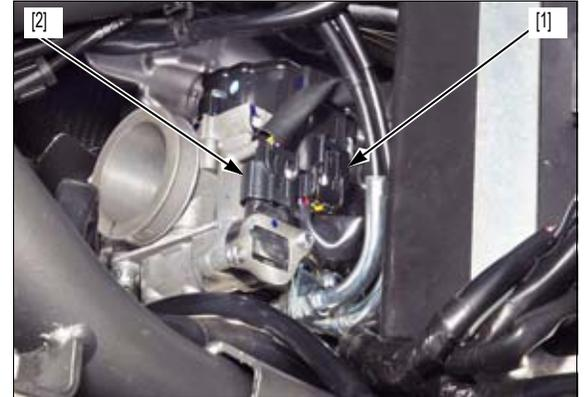
Afloje la contratuerca del dispositivo de ajuste cable del acelerador A [1] y la tuerca de ajuste [2], a continuación, desconecte el cable del acelerador A [3] del tambor del acelerador y del soporte del cable.
