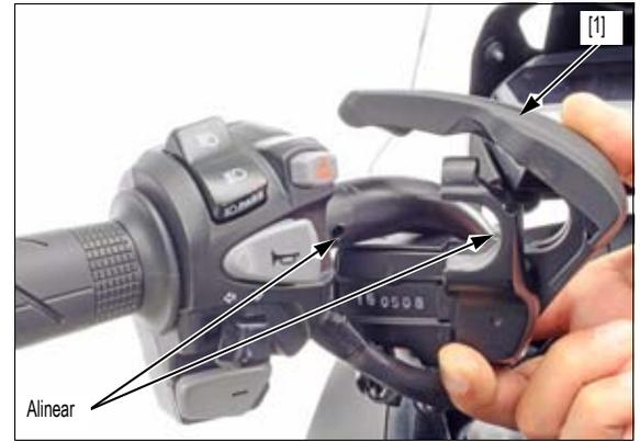
*XD/SD:* Instale el soporte [1] y los tornillos de cabeza embutida [2].
