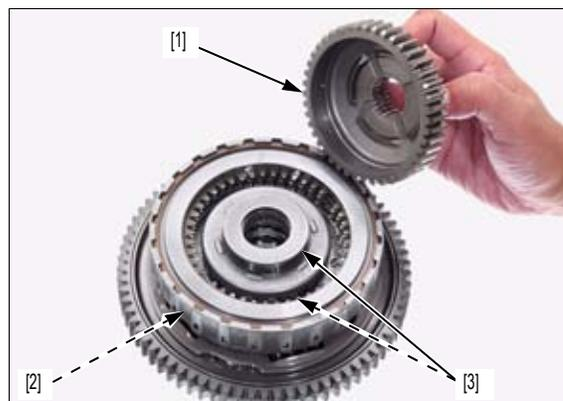
Extraiga los conjuntos del embrague [1] y las juntas tóricas [2] del engranaje conducido primario.
