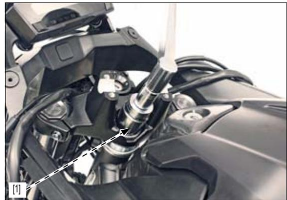
X: Instale la abrazadera del manguito del freno [1] y el tornillo [2] en el puente inferior.
