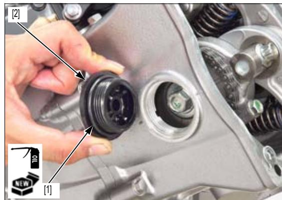
Si se monta el motor en el bastidor, introduzca una galga de espesores (0,1 mm) [1] entre el tapón de mantenimiento del árbol de levas y la culata.
