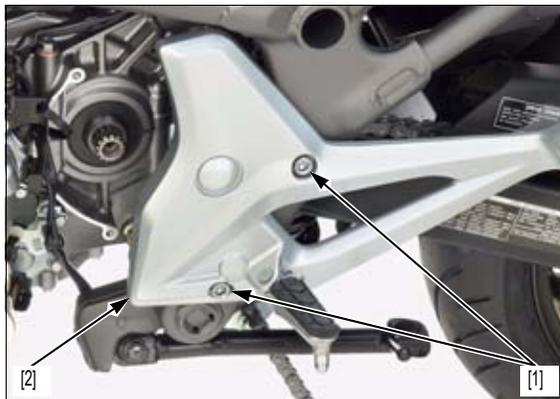
Desmonte los tornillos de cabeza embutida de fijación de la estribera [1] y la estribera derecha [2].
