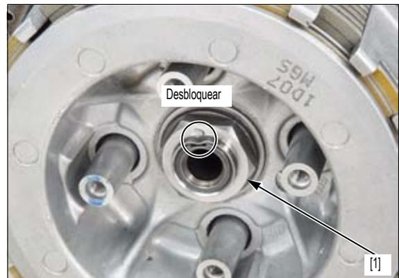
Sujete el plato de presión del embrague con la herramienta especial y afloje la contratuerca central del embrague [1].
