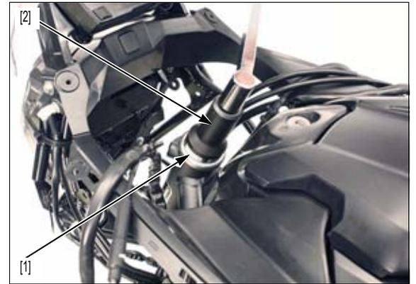
Monte una arandela de seguridad nueva [1] alineando sus aletas dobladas con las ranuras en la tuerca de ajuste del vástago de la dirección.
