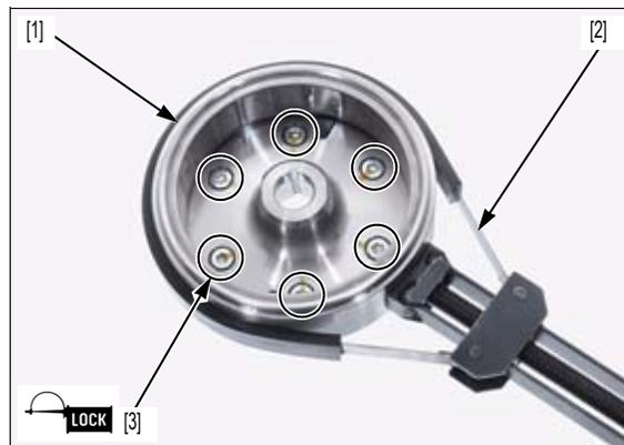
Monte el engranaje conducido del motor de arranque [1] en el exterior del embrague del motor de arranque mientras se hace girar este engranaje en el sentido antihorario.
