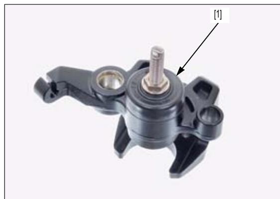
Desmonte el tornillo de ajuste/pistón del freno de estacionamiento [1] mientras sujeta el eje del freno [2].
