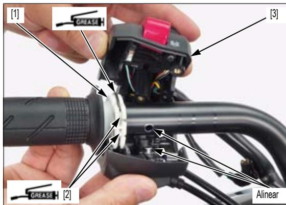
**XD/SD:** Monte los tornillos [1] y apriete primero el tornillo superior y, a continuación, el tornillo inferior al par especificado.
