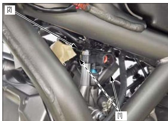
Afloje el tornillo de la abrazadera [1] y desconecte los manguitos de agua [2] de la bomba de agua.
