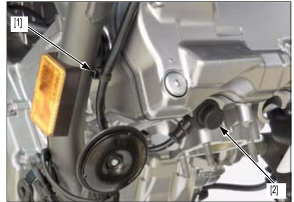
Instale la abrazadera para cables de la bujía [1] en el soporte.
