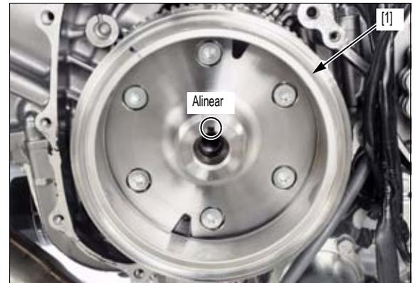
Aplique aceite de motor a las roscas del tornillo de fijación del volante de inercia y a la superficie de asiento.
