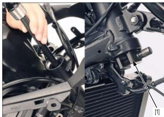
Monte temporalmente la tuerca del vástago de la dirección [1] en dicho vástago [2] para evitar dañar las roscas cuando desmante la pista interior inferior [3] del vástago de la dirección.
