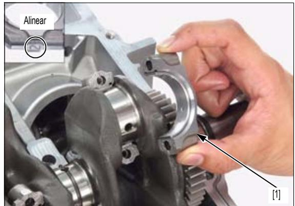
Utilice los tornillos de la tapa del cojinete de la muñequilla desmontados cuando compruebe la holgura de engrase.
