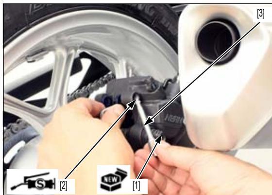
Apriete el tornillo de fijación de la pinza del freno trasero [1] al par especificado.
