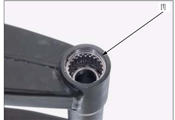
Extraiga el cojinete de agujas [1] y el cojinete de bolas [2] del pivote derecho con la herramienta especial y una prensa hidráulica.
