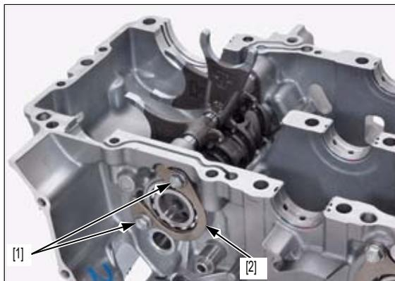
Desmonte el eje de la horquilla [1] y las horquillas de selección [2].
