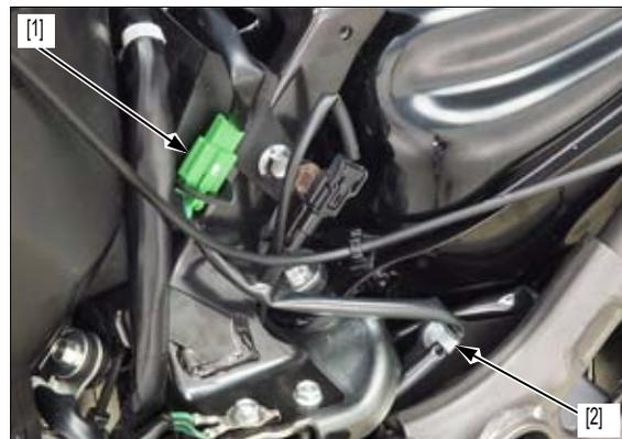
Desmonte la abrazadera para cables [1] y la abrazadera del cable del interruptor del caballete lateral [2].
