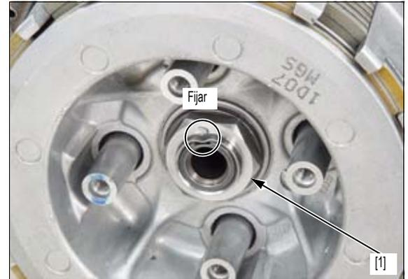
Instale los muelles del embrague [1], el cojinete/plato elevador del embrague [2] y los tornillos del plato elevador del embrague [3].
