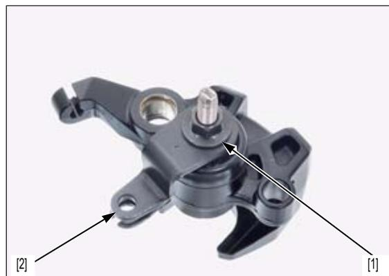
Desmonte la funda guardapolvo del eje del freno [1].
