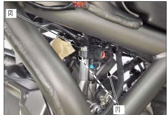
Desconecte el conector 3P (negro) del sensor de TR [1] y desmóntelo del soporte de la placa transversal central.
