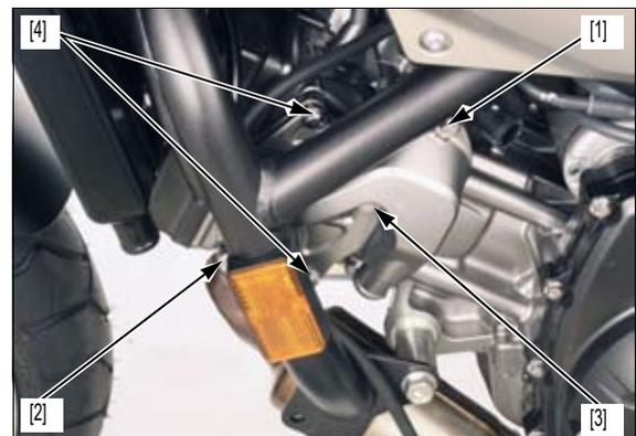
Desmonte y deslice el conjunto de la bomba de agua.
