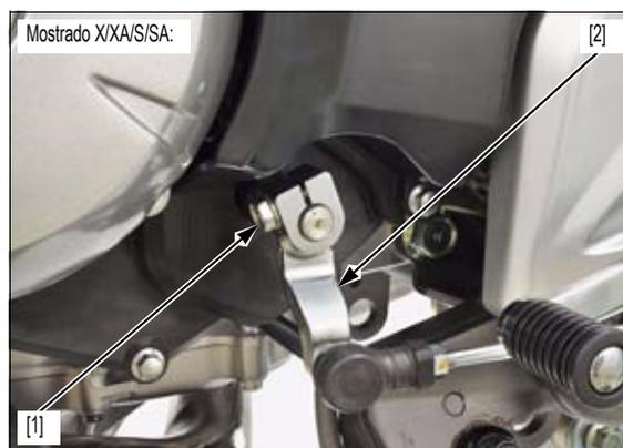
Desmonte los tornillos de cabeza embutida de fijación de la estribera [1] y la estribera izquierda [2].
