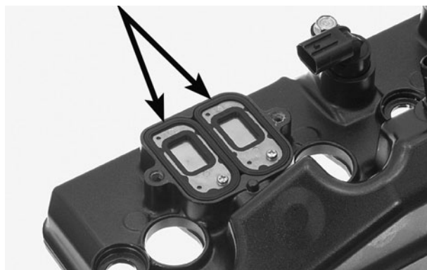
VÁLVULAS DE INSPEÇÃO PAIR
