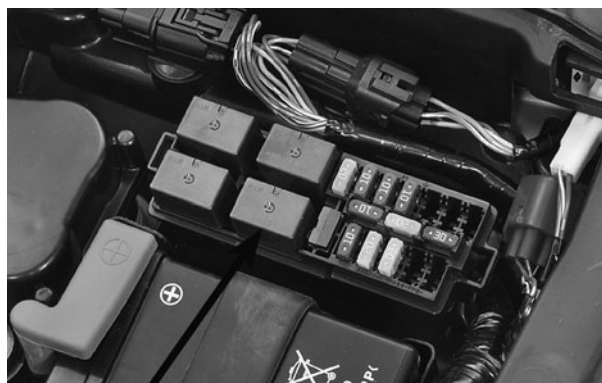
RELÉ DE PARADA DO MOTOR
