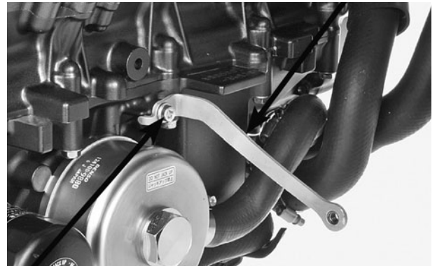
PARAFUSO CABO DO MOTOR DE PARTIDA CABO NEGATIVO (-) DA BATERIA CONECTOR DO INTERRUPTOR DE PONTO-MORTO
