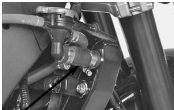
MANGUEIRA DE ÁGUA
