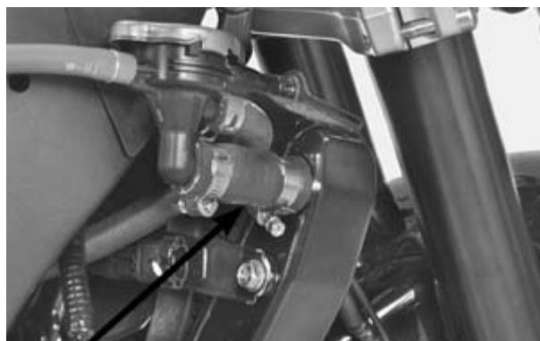
MANGUEIRA DE ÁGUA
