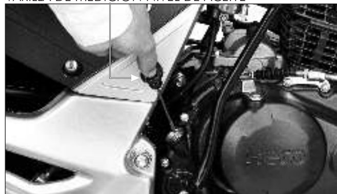
VARILLA DE MEDICIÓN NIVEL DE ACEITE
