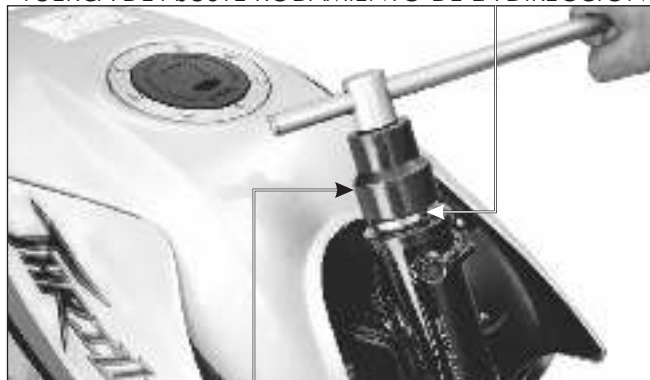
TUERCA SOCKET AJUSTE RODAMIENTO DE DIRECCIÓN ANILLO CONO SUPERIOR
