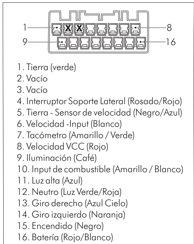
CONECTOR 16P CONSOLA DE MEDIDORES COMBINADOS
