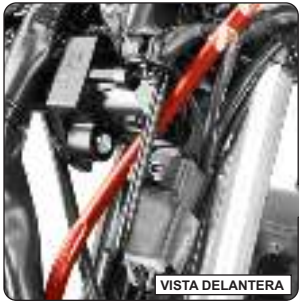
Cable del embrague direccionado por detrás del visor delantero
