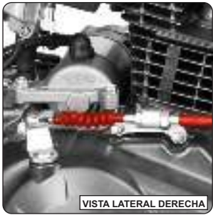
Cable del embrague direccionado a través del receptor cárter derecho
