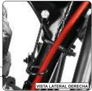
Cable del embrague direccionado a través de la guía en el marco encima de la garganta del silenciador
