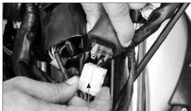
CONECTORES DEL RELÉ INTERRUPTOR DE PASO
