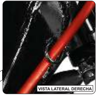
Cable del embrague direccionado a través de la guía en el área del vástago de la dirección
