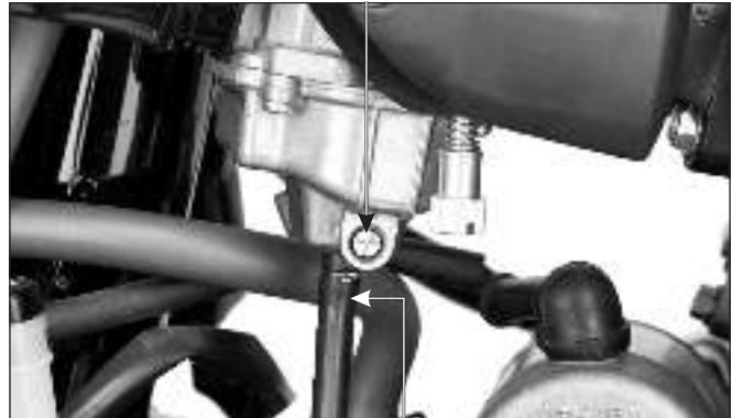
TUBO DE DRENAJE
