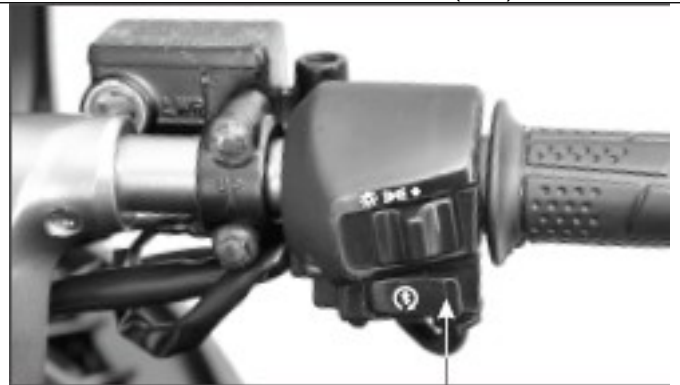
INTERRUPTOR DE ENCENDIDO ELÉCTRICO
