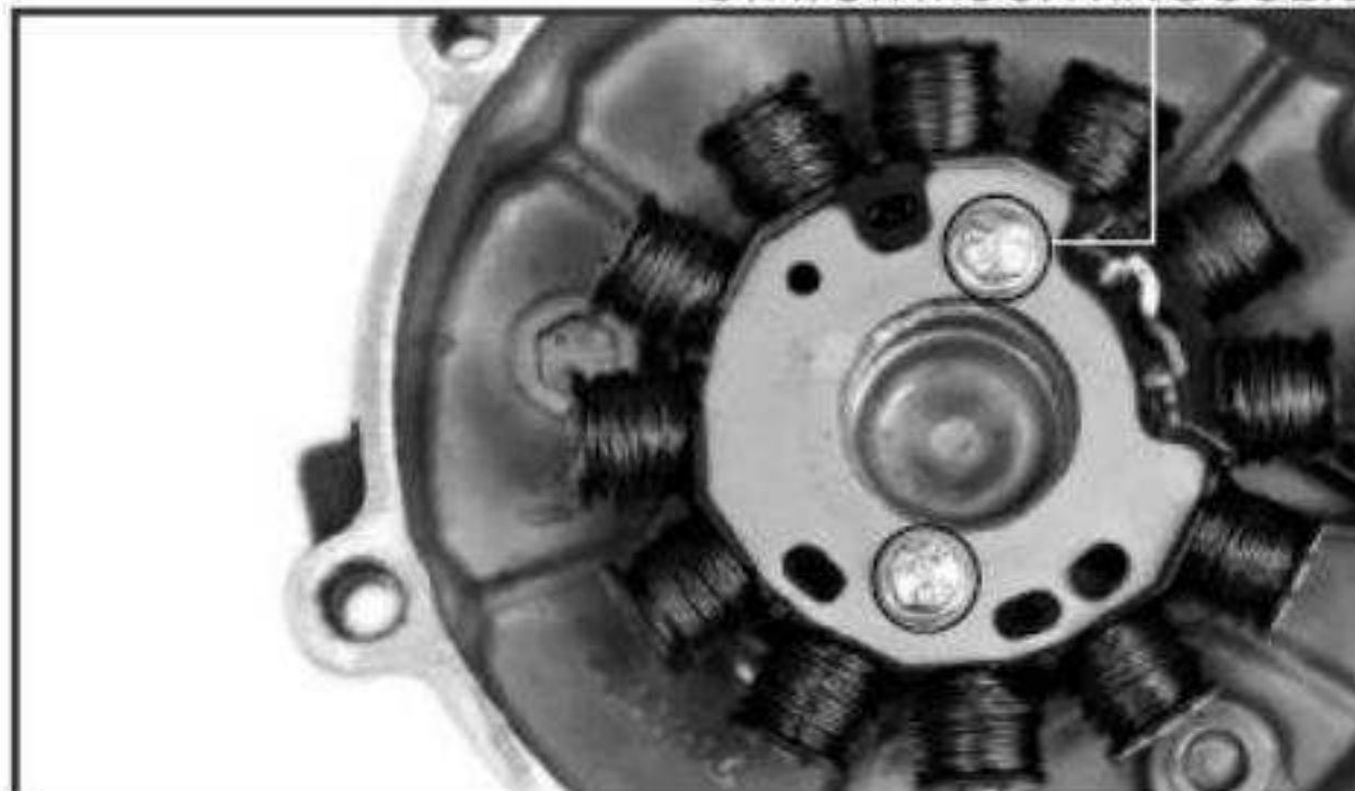
Pernos de montaje del estator
