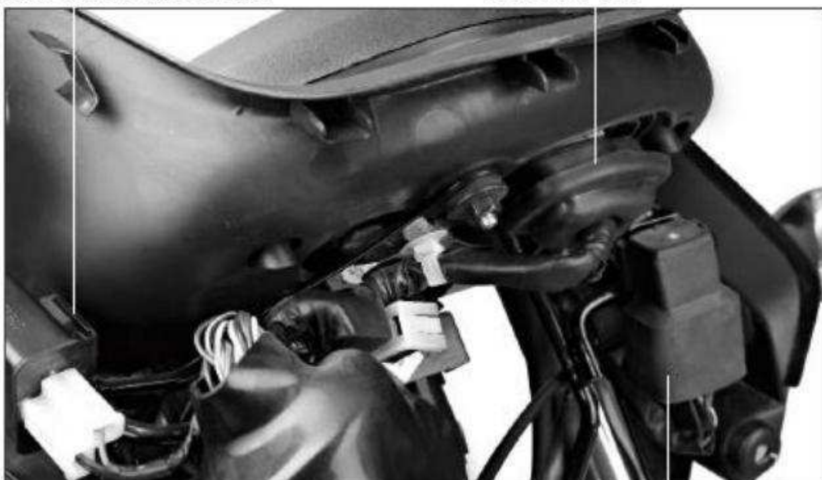
Relé suiche de paso
