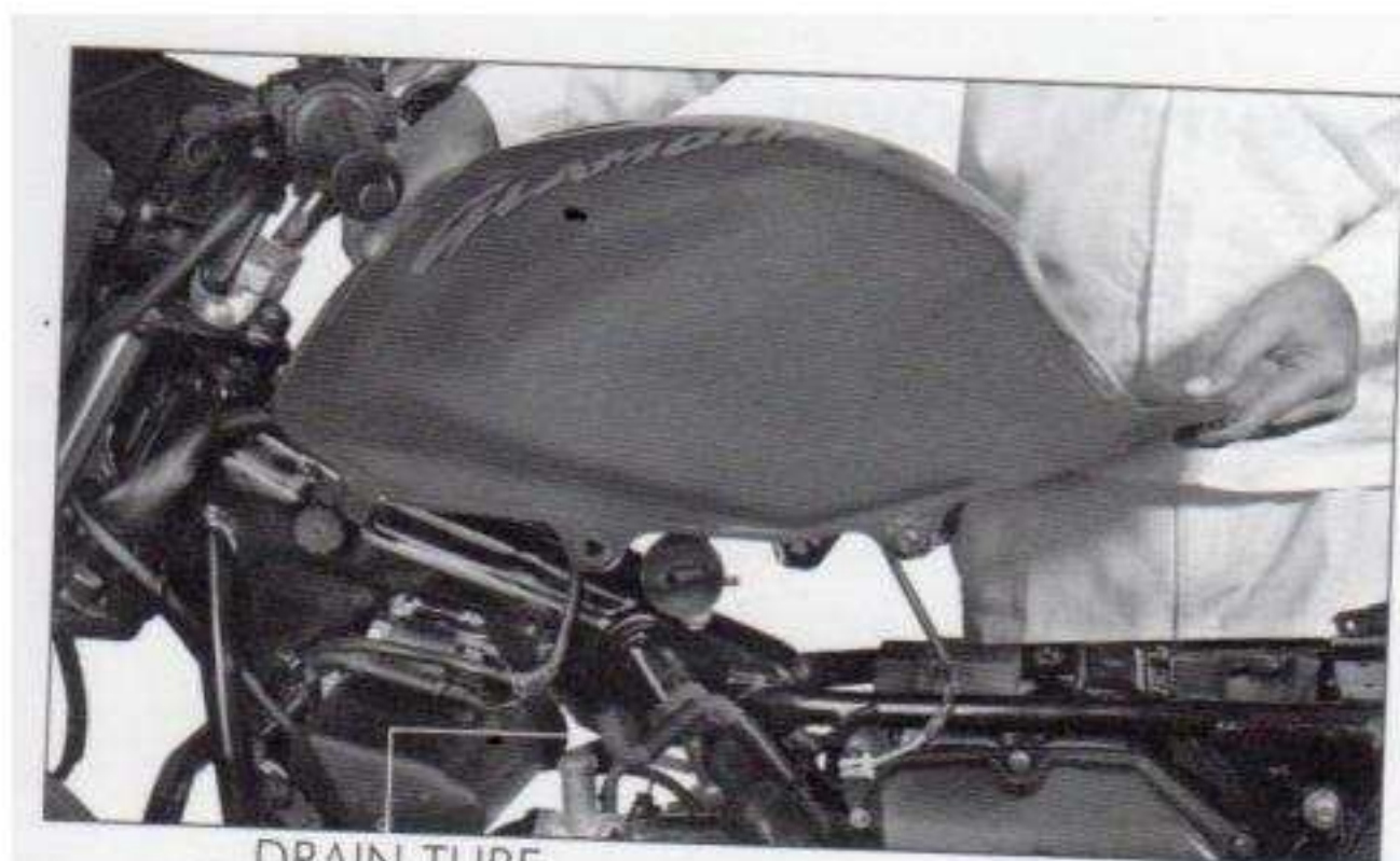
Tubo de drenaje
