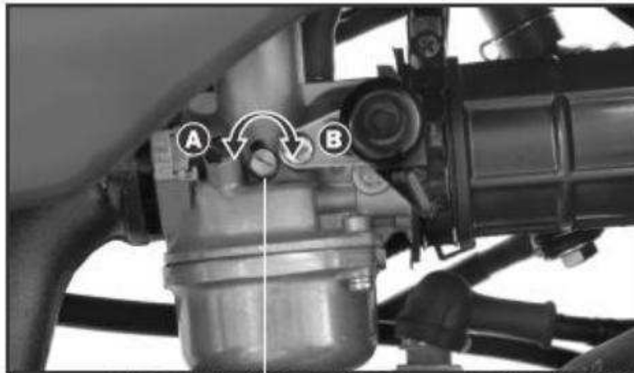
Tornillo tope del acelerador A Disminuye RPM B Aumenta RPM
