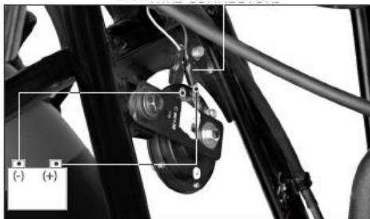
Conectores del cable
