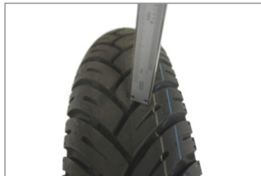
Profundidad de la banda de rodadura
