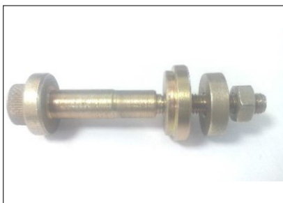
Herramienta para Desarmar el Embrague
