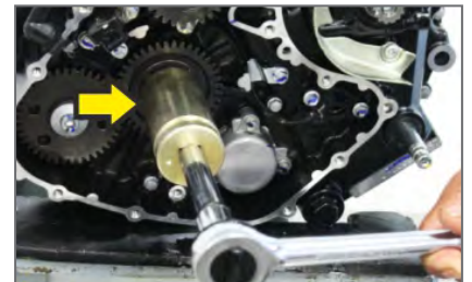
Montaje Conductor Balanceador
