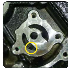
Entrada Bomba de Evacuación
