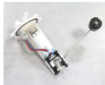
6 - Bomba de Combustible
