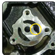
Salida Bomba de Evacuación
