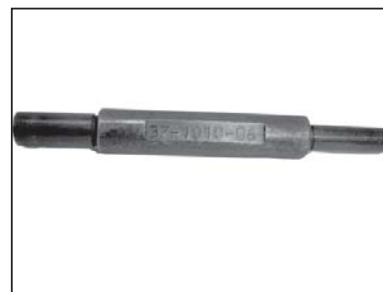
Extractor pín piston Parte No. : 37 1010 06 Aplicación : Retirar y montar el pín del pistón
