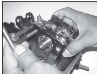
Extractor de balancines Parte No. : 37 10CS 22 Aplicación : Remover balancines de la culata
