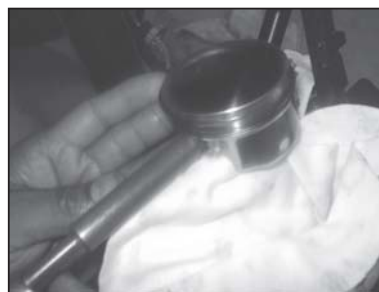
Extractor pín piston Parte No. : 37 1010 06 Aplicación : Retirar y montar el pín del pistón
