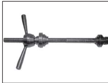
Instalador de cunas de dirección
