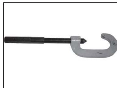
Sujetador de piñon de salida Parte No. : 37 1030 53 Aplicación : Para retirar y montar fácilmente el piñon de salida
