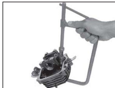
Compresor resorte de válvulas Adaptador parte No. : 37 1031 08 Compresor: 37 1031 07 Aplicación : Para montar y desmontar las válvulas del vehículo.
