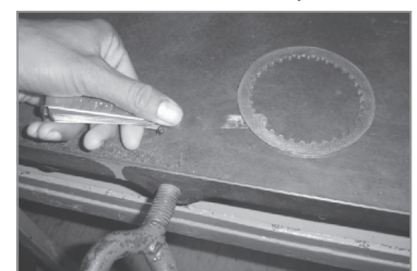
Deformación del disco separador
