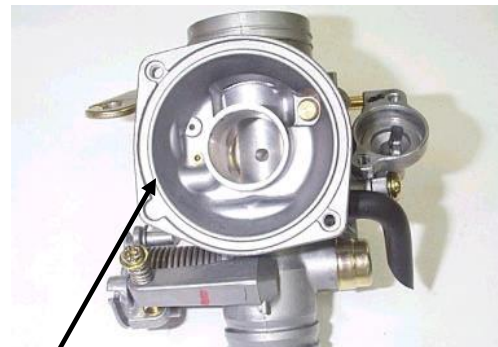
Pistón del diafragma, posición de bloqueo
