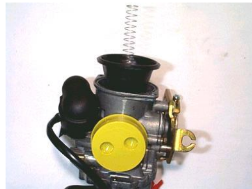
Pistón del diafragma, posición de bloqueo
